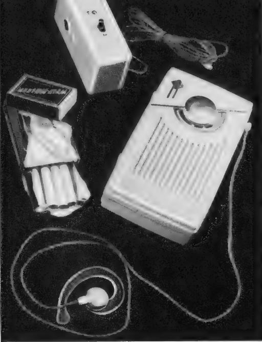
Bild 3. Transistor-Taschen-Super Telefunken TR 1; links oben das Netzgerät
