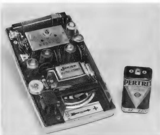
Bild 2. Innenansicht des 6-Transistoren-Taschen-Supers Telefunken TR 1, daneben die 22,5-V-Batterie
